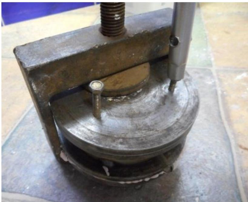
Рисунок 13. Удаление винтов из кюветы с помощью торцевого ключа после полимеризации пластмассы
