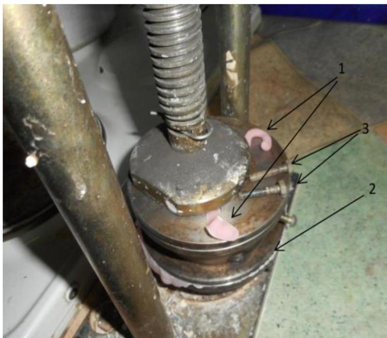
Рисунок 11. Паковка пластмассового «теста» под прессом
