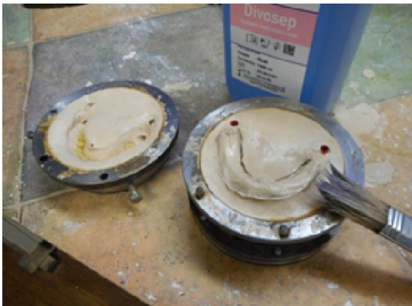
Рисунок 10. «Штамп» и «контрштамп» после покрытия изоляционным лаком
